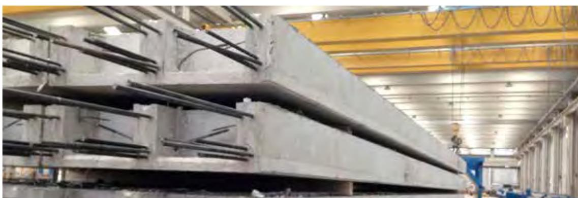
Lastra di solaio autoportante ad armatura precompressa
